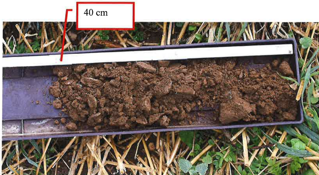
Figure 11 : Horizon A déterminé à l'aide d'une tarière
