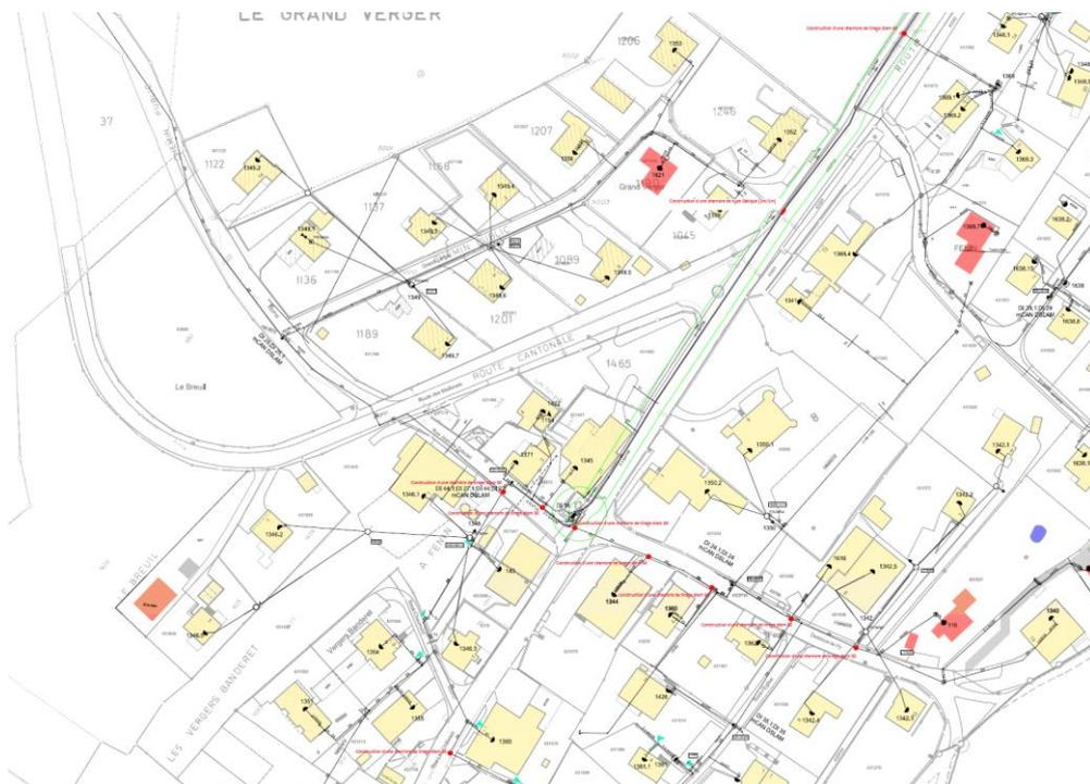
Figure 33: Projet de télécommunication - nouvelles chambres de tirage des câbles (source : projet Swisscom SA)
