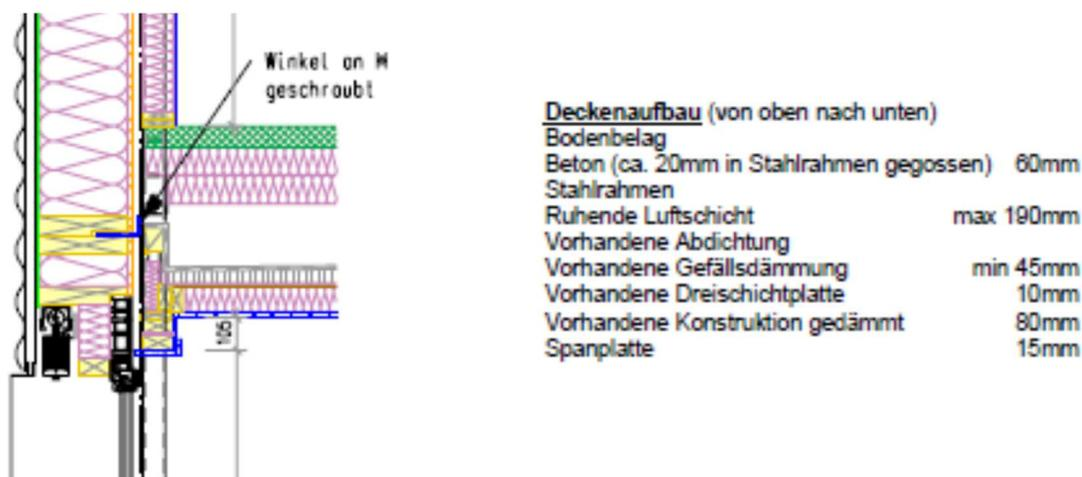
Les panneaux acoustiques envisagés représentent une charge supplémentaire de l'ordre de 17.0 kg/m<sup>2</sup> et l'objectif de l'analyse est de déterminer si les fixations du plafond existant ont une réserve de capacité portante suffisante pour assumer le surplus de charge représenté par les éléments acoustiques.
