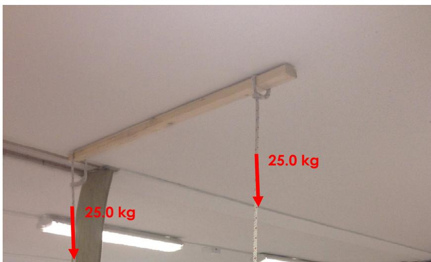
L'essai a été réalisé en fixant au plafond une latte en bois d'une longueur approximative de 1.0 mètre, pourvue de deux suspentes auxquelles les charges d'essai ont été accrochées.
