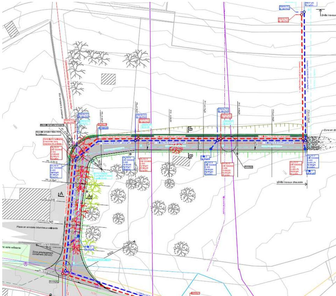
Figure 2 : schéma final d'évacuation des eaux claires et usées
