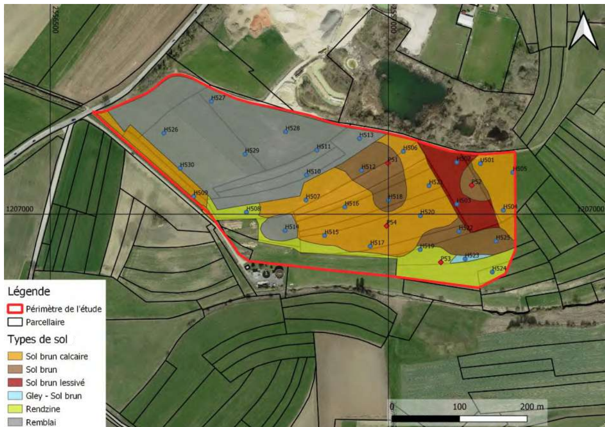
Figure n° 16 : Carte des types de sol présents dans la zone n° 5 et localisation des sondages et profils de sol
