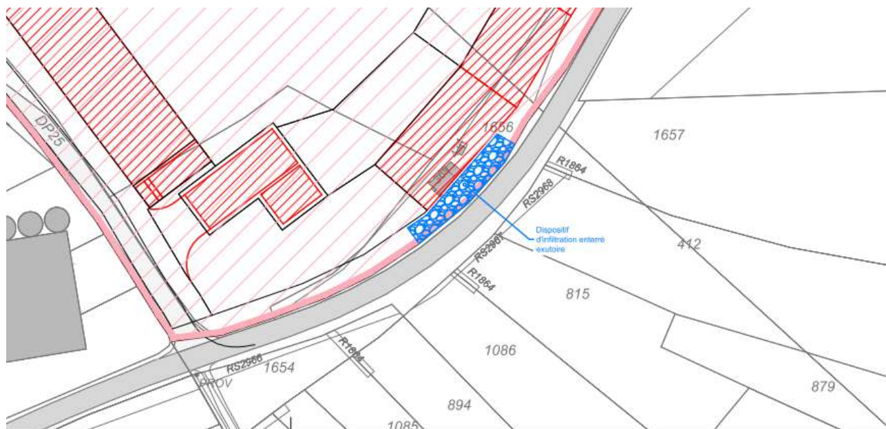
Figure 7: Ouvrage d'infiltration au Sud du secteur et en parallèle à la route cantonale (Source: VBI SA)
