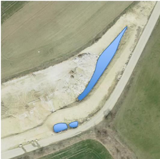
Printemps 2017 : l'aménagement d'une digue entraîne la formation de l'étang principal, couvrant près de 340 m<sup>2</sup> ; les matériaux visibles à l'ouest du plan d'eau serviront à combler une partie de la dépression en début d'été 2017, entraînant une importante réduction de la surface en eau
