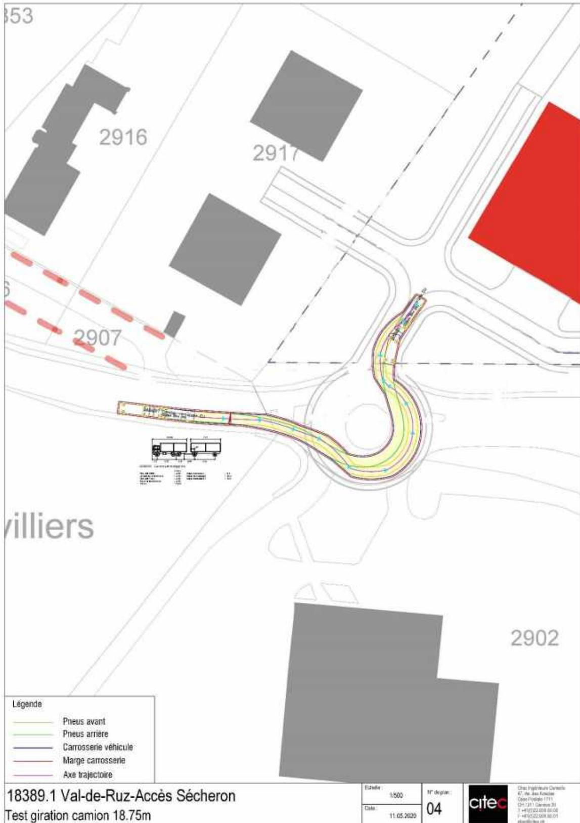
Figure 9 – Vérification des girations d'un camion-remorque accédant au site depuis l'ouest (tourne-à-gauche via giratoire du SCAN)
