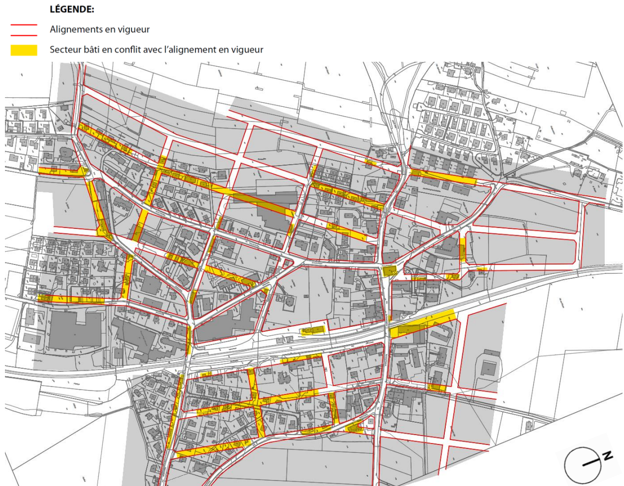
Figure 5 : Plan de synthèse des secteurs de conflit : superposition du plan d'alignement et du cadastre actuel.
